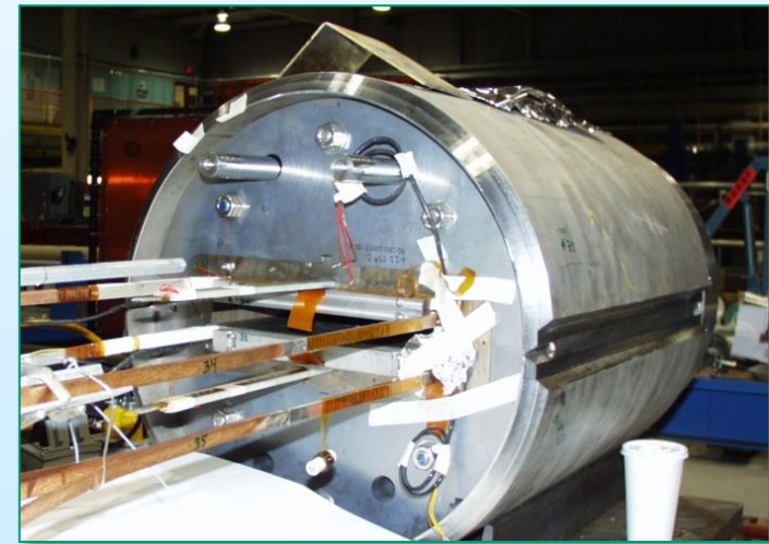
BNL “React & Wind” 10 T Nb 3 Sn Dipole
